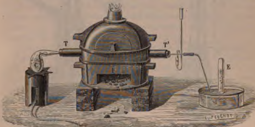
Fig. 14. — Décomposition de la vapeur d'eau par le fer. C, Eau en ébullition. — TT, Tube plein de copeaux de fer. — E, Éprouvette à gaz.
